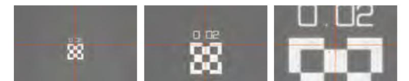
1X Campo de visão: 0.62x0.47 mm 2X Campo de visão: 0.31x0.23 mm 6X Campo de visão: 0.10x0.07 mm
