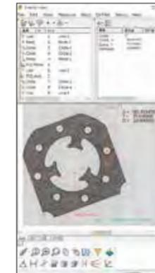
Este recurso não só pode ser usado para relatórios de resultados de medição, mas também cálculos de alto nível, como cálculos entre elementos e medições de PCD, podem ser realizados selecionando diagramas com o mouse. Além disso, o uso eficaz da função gráfica torna possível editar facilmente programas de peças e também é útil na verificação do sistema de coordenadas da peça atual e na verificação de medições esquecidas.
