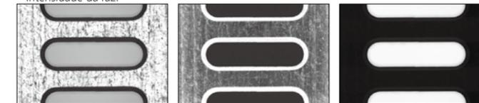
Iluminação de superfície Iluminação anelar programável Iluminação de contorno
